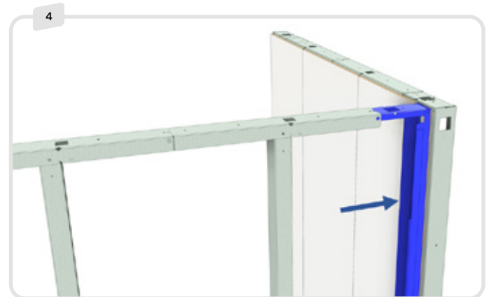
Schieben Sie das C-Modul gegen die Platten und befestigen Sie es dort, wo es erforderlich ist. Faites glisser le module C contre les panneaux et fixez-le si nécessaire. Far scorrere il modulo a C contro i pannelli e fissarlo dove necessario.
