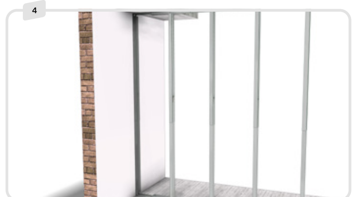
Lassen Sie das C-Modul oben in das I-Modul einrasten und fixieren Sie es. Clippez le module C en haut dans le module I et fixez le tout. Unire il modulo a C con il modulo a I in alto e fissarlo in posizione.
