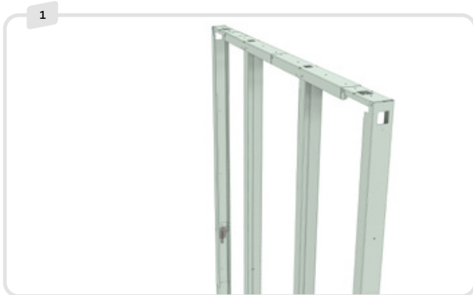
Positionieren und befestigen Sie die erste Modulstruktur. Placez et fixez la structure de 1 ère module. Posizionare e fissare la struttura del 1° modulo.
