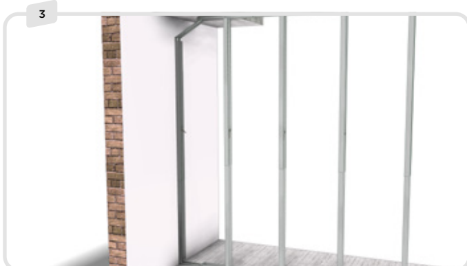
Schieben Sie das C-Modul gegen die Ecke. Faites glisser le module C contre le coin. Far scorrere il modulo a C contro l'angolo.
