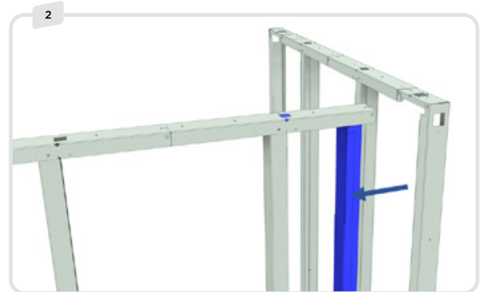
Positionieren Sie die abgewinkelte Modulstruktur, aber befestigen Sie das angrenzende C-Modul (blau) noch nicht; schieben Sie es nach links. Placez la structure de module perpendiculaire, mais ne fixez pas encore le module C adjacent (bleu) et faites le glisser vers la gauche. Posizionare la struttura del modulo ad angolo, ma non fissare ancora il modulo a C adiacente (blu); farlo scorrere a sinistra.
