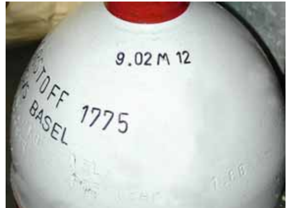
Bild 24: Prüfdatum auf Gasflaschenschulter
