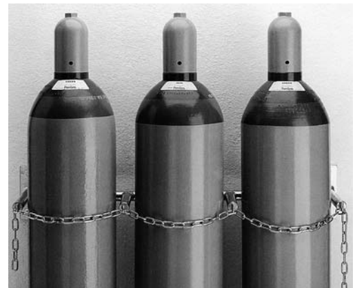
Bild 3: Sicherung der Gasflaschen mit Ketten.
