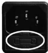
Fig. 66 - Abdeckklappe mit Sicherungen, die ausgewechselt werden müssen
