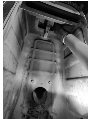
Fig. 64 - Die Asche absaugen
