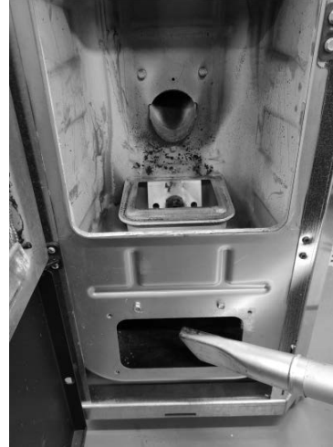
Fig. 62 - Die Asche absaugen
