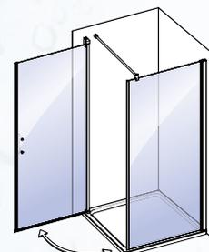
*Zwei Einbaumöglichkeiten mit den gleichen Systemelementen*
