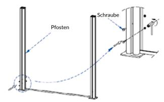
**Version 2: Einbetonieren -** Betonieren Sie die Pfosten ein und stellen Sie sicher, dass diese fest verankert sind. Tipp: Halb in den Pfosten eingedrehte Schrauben erhöhen die Verbindung zwischen Beton und Pfosten und sorgen für zusätzliche Stabilität. Der Beton sollte bis zum unteren Rand der Abstandhalter aufgefüllt sein, um diese ausreichend abzustützen.
