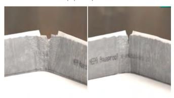
Schneiden Sie hierzu eines neues Stück Aquaproof zu und trennen Sie den unteren Butylstreifen ab. Verwenden Sie nur den Butylstreifen ohne Vliesgewebe.
