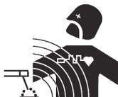
Электрический ток, проходящий через проводник вызывает электромагнитные поля (EMF). Сварщики должны следовать следующим правилам безопасности, чтобы до минимума снизить воздействие электромагнитных полей сварочной цепи :
