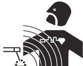
Le correnti elettriche traversano un conduttore causando campi elettrici e magnetici (EMF). I saldatori dovrebbero seguire le istruzioni sottostanti per ridurre al minimo l'esposizione ai campi elettromagnetici del circuito di saldatura:
