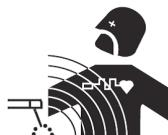
La corriente eléctrica causa campos electromagnéticos (EMG) al atravesar un conductor. Los soldadores deben seguir las instrucciones siguientes para reducir al mínimo la exposición a los campos electromagnéticos del circuito de soldadura:
