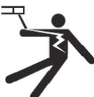
Das Schweißgerät darf ausschließlich an einer geerdeten Netzversorgung angeschlossen werden. Verwenden Sie nur die empfohlenen Sicherungen. Das Berühren stromführender Teile kann tödliche elektrische Schläge oder schwere Verbrennungen verursachen.
