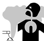
Dampen, gassen en stof uitgestoten bij het lassen zijn gevaarlijk voor de gezondheid. Zorg voor goede ventilatie en verse lucht tijdens het lassen. Een lashelm met frisse lucht aanvoer kan een oplossing zijn als er onvoldoende ventilatie is.
