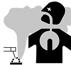
Beim Plasmaschneiden entstehen Rauchgase bzw. toxische Dämpfe, die zu Sauerstoffmangel in der Atemluft führen können. Sorgen Sie daher immer für ausreichend Frischluft, technische Belüftung (oder ein zugelassenes Atmungsgerät). Verwenden Sie die Schneidanlagen nur in gut belüfteten Hallen, im Freien oder in geschlossenen Räumen mit ausreichend starker Absaugung, die den aktuellen Sicherheitsstandards entspricht.
