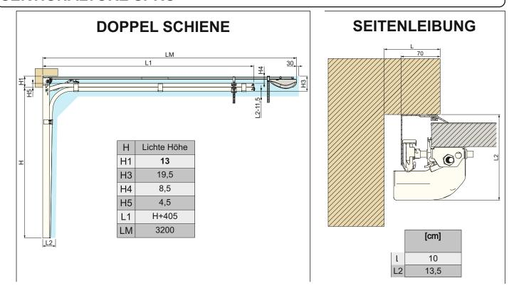
Im Öffnungszustand nimmt das Bodenpaneel 2-3 cm der lichten Höhe ein. Seilhalterung, Seitenscharniere, Innengriff und Innenverriegelung können bis 8.5-9 cm einnehmen.
