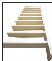
3. Stufen verschrauben und verleimen
